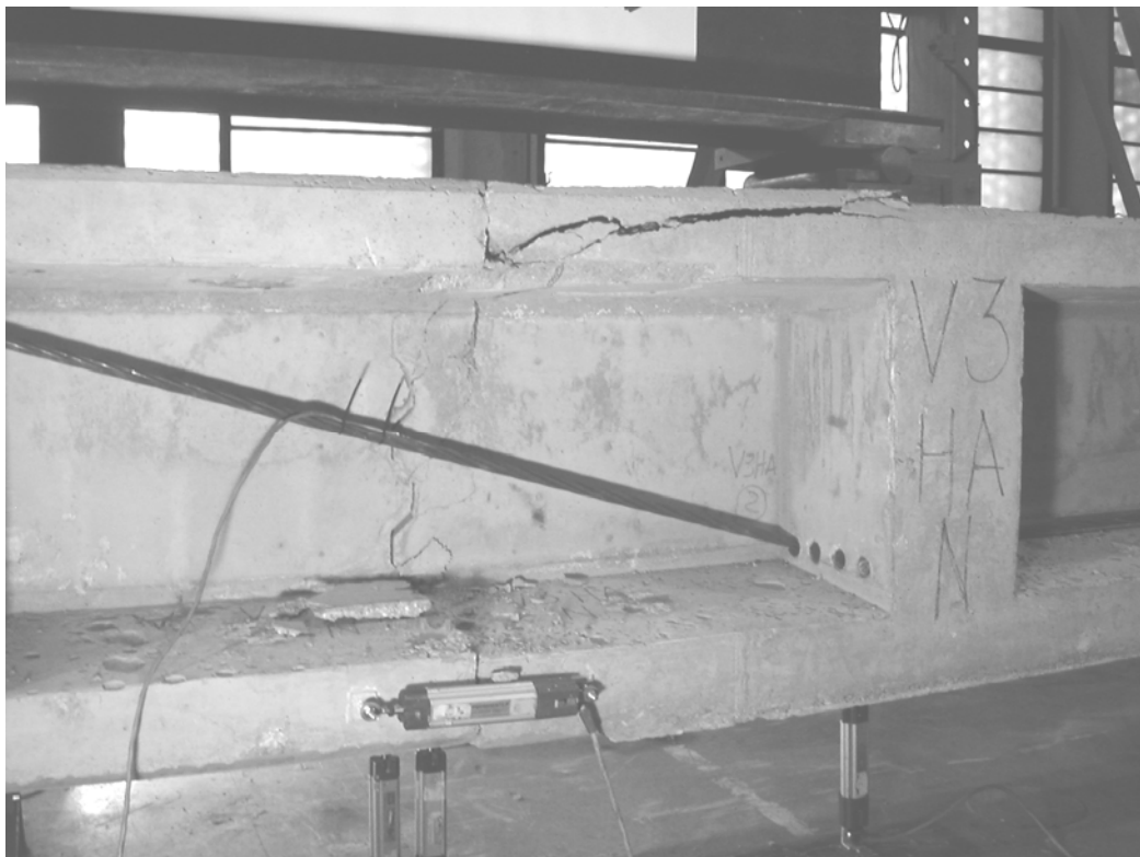
Figura 20. Ensayo V3-HA. Fase de prerrotura (a) y viga descargada (b).
